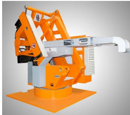
Bild 2: Schwerlastroboter DDS SLR 5 E mit elektromechanischen Antrieben und Parallel-Hebelsystem mit linearer Vorschub-Kopplung.
